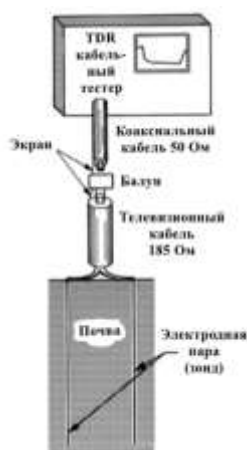
Рисунок 8 – Основные компоненты, применяемые для определения влажности почвы TDR методом с помощью двухстержневого зонда [10]
