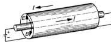
Рисунок 5 – Коаксиальная линия: E - напряженность электрического поля; B - магнитная индукция; I - электрический ток
