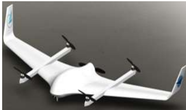
Şəkil 1 – “Uçan qanad” korpusunun CAD proqram təminatı bazasında hazırlanmış sxemi
