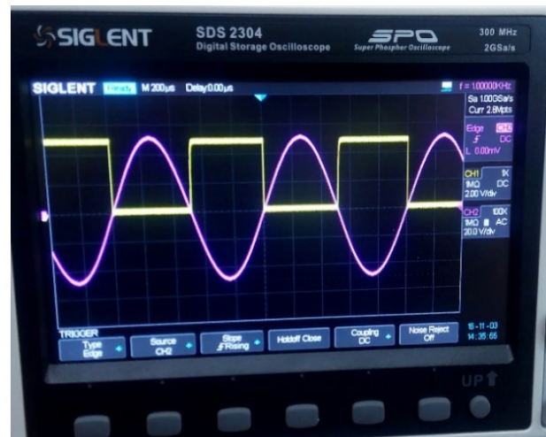
Şəkil 3 – Generatorun çıxışında əldə olunan siqnalların ossilloqrafik təsvirləri
