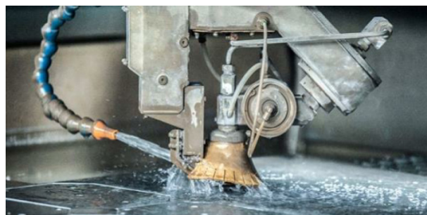
Рисунок 2 – Контурная резка абразивной струей Figure 2 – Contour cutting with an abrasive jet
