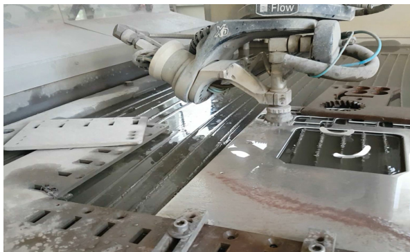
Рисунок 7 – Процесс водоструйной резки Figure 7 – Water jet cutting process
