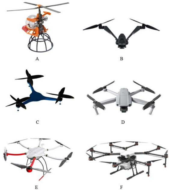
Şəkil 4 – Fırlanan qanadlı PUA növləri (A: monokopter; B: bikopter; C: trikotper; D: kvadrokopter; E: heksakopter; F: oktokopter)
