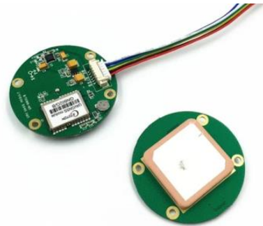
Şəkil 6 – PUA-larda istifadə edilən GPS modulu Figure 6 – GPS module used in UAVs
