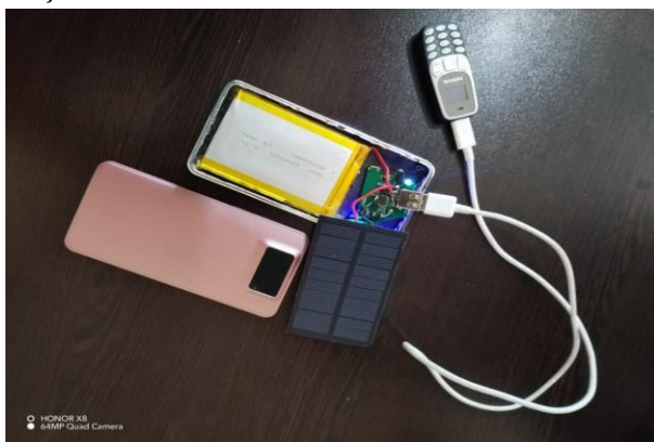
Şəkil 2 – Günəş elementinə birləşmiş mobil telefon Figure 2 – Mobil Phone connected to the solar element
