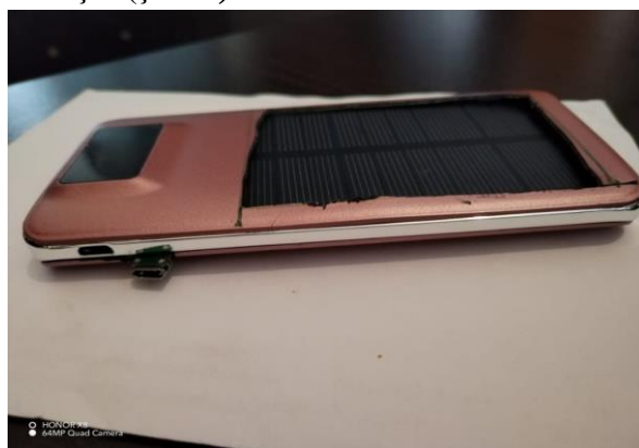
Şəkil 3 – Günəş elementli yeni PowerBank Figure 3 – New PowerBank with solar cell
