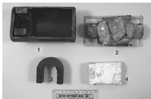
Şəkil 1 – Partlayıcı qurğunun əsas hissələri (1 - partlayıcı qurğunun qutusu; 2 – partlayıcı maddənin enerji mənbəsi 3 – maqnit; 4- plastik partlayıcı maddə (C-4))
