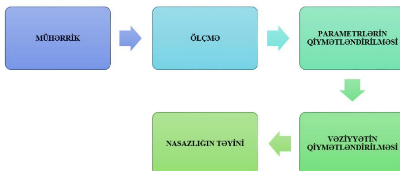
Şəkil 1 – Parametrlərin qiymətləndirilməsi əsasında mühərrik nasazlığının diaqnostikası Figure 1 – Diagnosis of motor failure based on parameter evaluation
