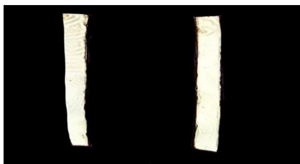
Рисунок 4 – Фотографический снимок 180-дневных образцов эмали на основе наноталька (слева) и наномела (справа)
