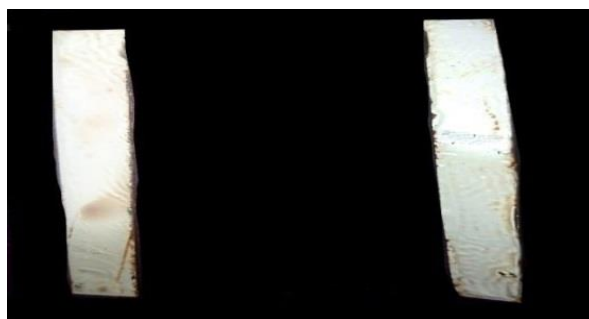
Рисунок 3 – Фотографический снимок 180-дневных образцов эмали на основе талька (слева) и мела (справа)
