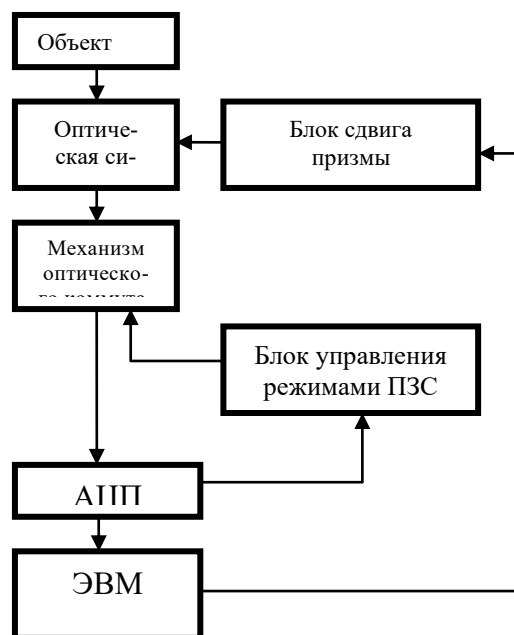
Рисунок 3 – Структурная схема специализированной телевизионной измерительной системы
