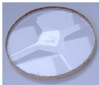
Рисунок 4 – Диск с клиновидными призмами Figure 4 – A disk with wedge-shaped prisms
