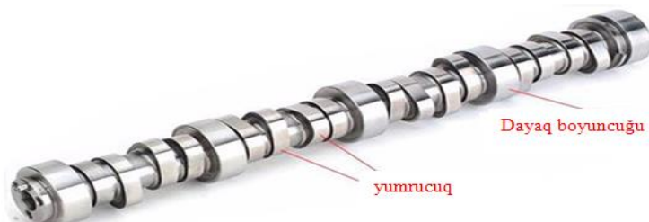
Şəkil 2 – Yığma konstruksiyalı paylayıcı val
